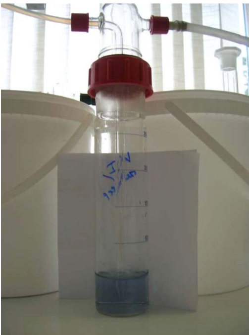
Figuur 3: Blauwkleuring van de KI/zetmeel-oplossing na rechtstreekse bemonstering van een chloor/CO 2 gasstroom aan de gasverdeelleiding
