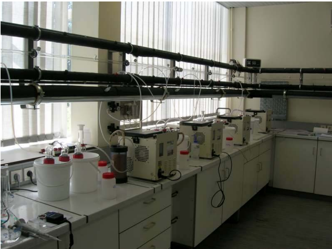
Figuur 2: Bemonstering van een gasroom met chloor en CO 2 met 4 simultane opstellingen met verschillende absorptie-oplossingen (0,1-0,5-1 N NaOH en 0,1 N As 2 O 3 in 0,2 N NaOH)
