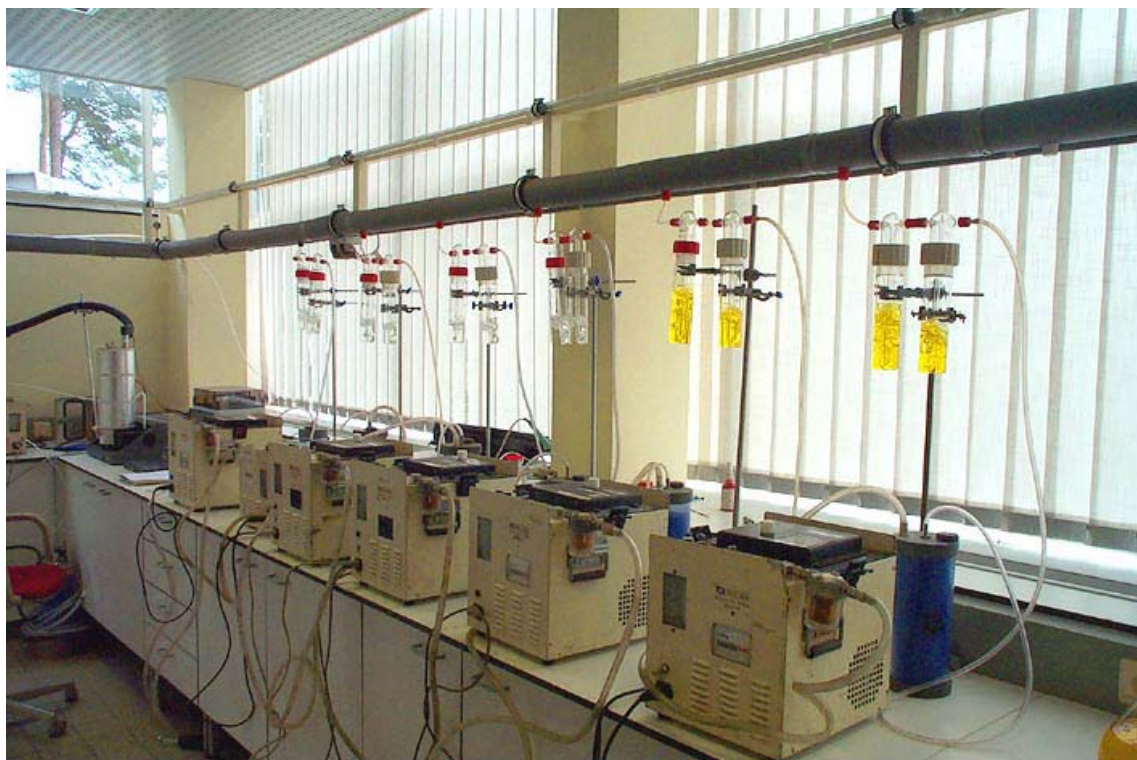
Figuur 2: Verschillende opstellingen voor bemonstering van formaldehyde in een gasstroom (rechts: bemonstering in 2,4-DNPH)
