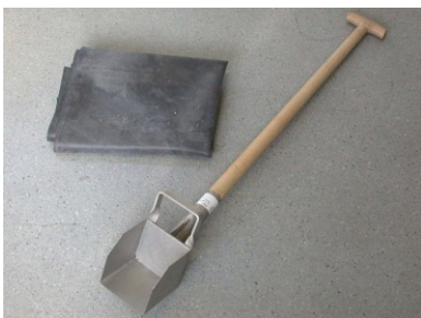
Figuur 16: bemonsteringsschop met rechtopstaande rand
